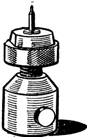
Рис. 14. Цанговый патрон для сверления центровых отверстий на токарном станке.
